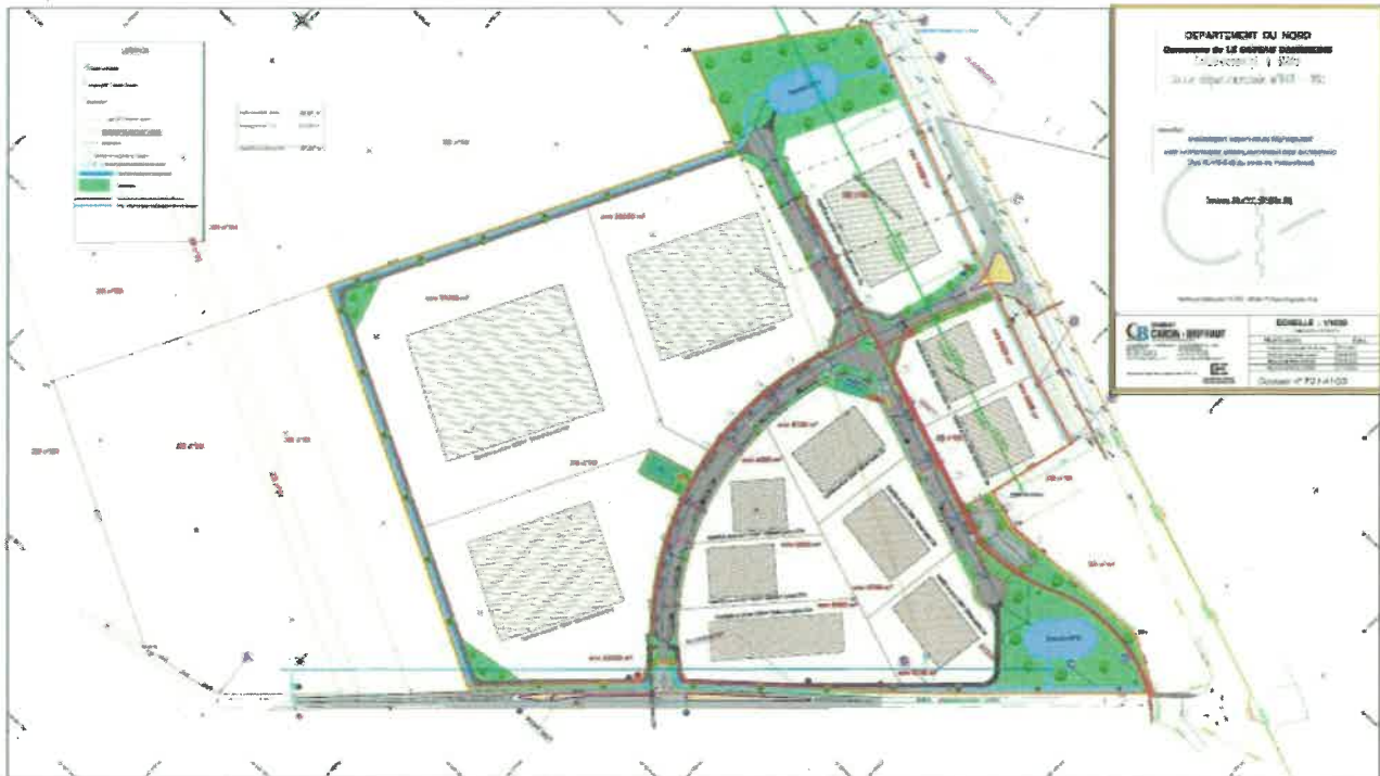
Figure 3 : Hypothèses d'implantation des bâtiments sur la zone : plan masse (CA2C / Dèle VRD / Caron-Briffaut / Geomètre Expert)
