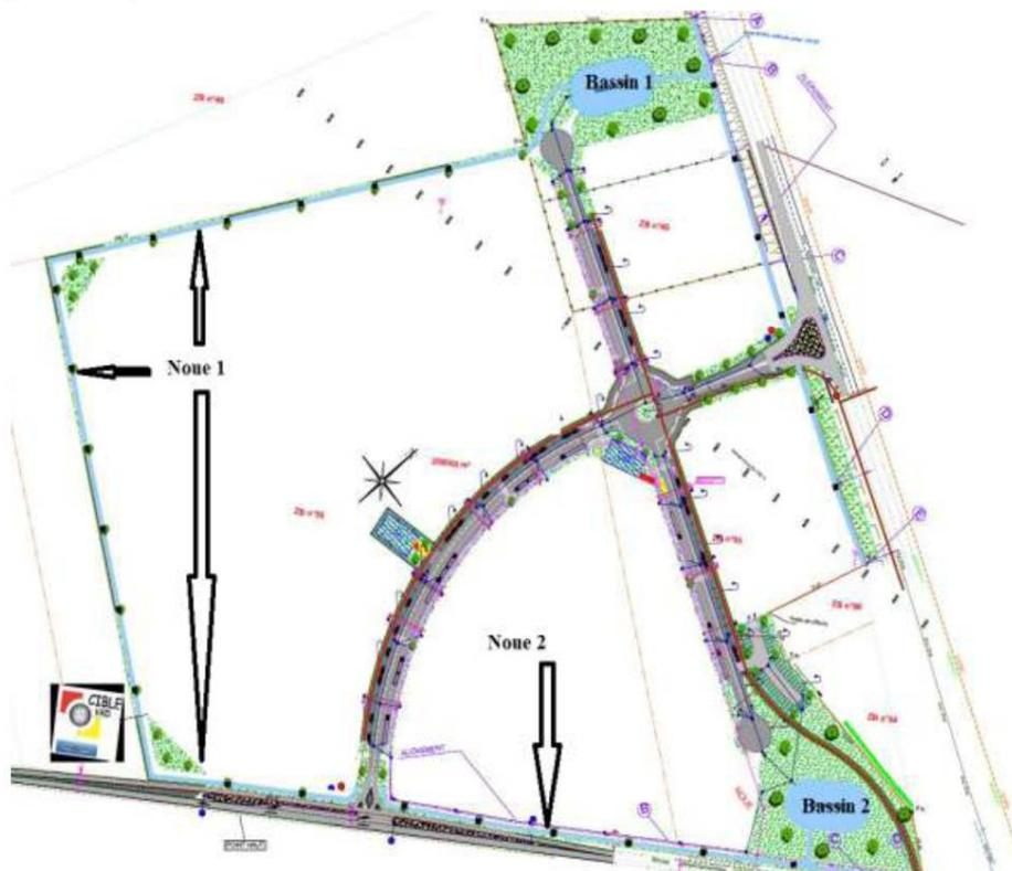
Figure 9 : Gestion des eaux pluviales
